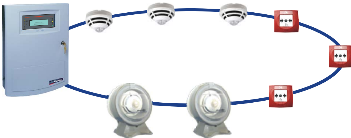
Fig. 26: Vigilon loop wiring
